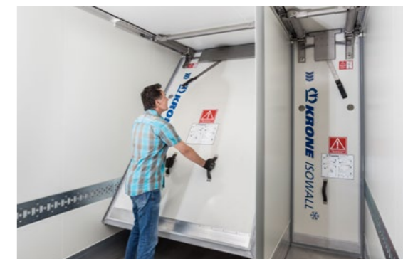
Isowall Quer-Trennwand und flexible Zusatzverdampfer im Cool Liner: maximale Freiheit für die Auslegung und das Handling von Mehrkammer-Systemen.
